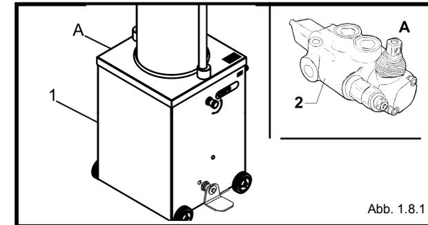
1. Schutzgehäuse für Elektro- und Hydraulikkomponenten
